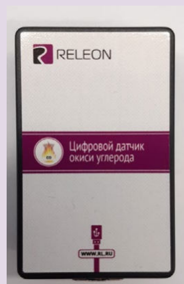
Рис. 11. Датчики кислорода (слева) и угарного газа (справа)
